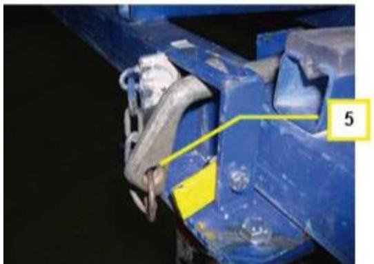
Auf dieser Darstellung sehen Sie die richtige und sichere Positionierung des Splinten in Zusammenarbeit mit dem Sicherungshebel.
