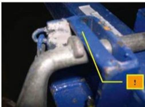
Die am Splinten angebrachte Nocke muss sich im hinteren Schlitz befinden. Der Splinten muss immer in die dafür vorgesehene Position gedreht werden, damit der Glasbock sicher zu bedienen ist.
