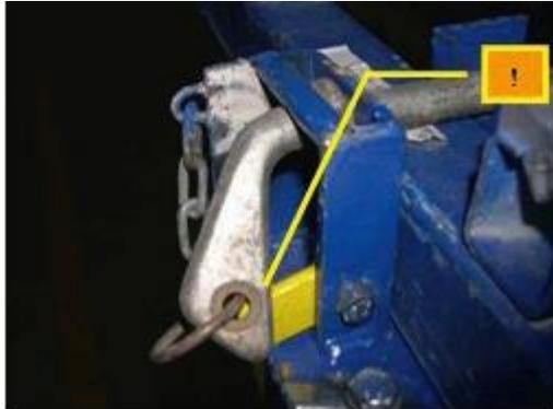
Hier ist der Griff des Splinten vor dem Sicherungshebel und sichert ihn deshalb nicht mehr vor einem möglichen Herausfallen.
