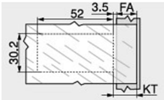
Der Frontaufschlag FA wird durch das Klebmass K bestimmt.
